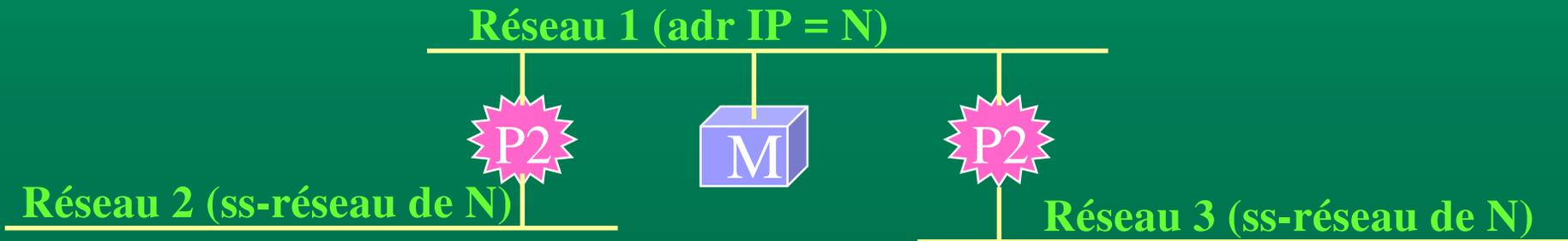
**M doit utiliser le routage de sous-réseaux pour décider si elle route vers les passerelles P1 ou P2 bien qu'elle même soit connectée à un réseau (Réseau 1) n'ayant pas de sous-adressage**
