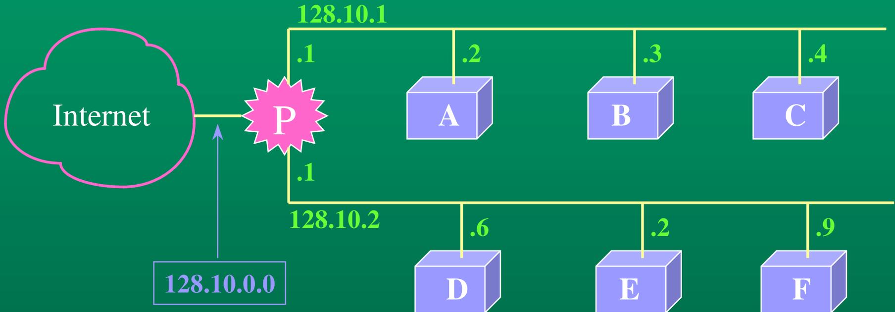
Un site avec deux réseaux physiques utilisant le sous-adressage de manière à ce que ses deux sous-réseaux soient couverts par une seule adresse IP de classe B.
