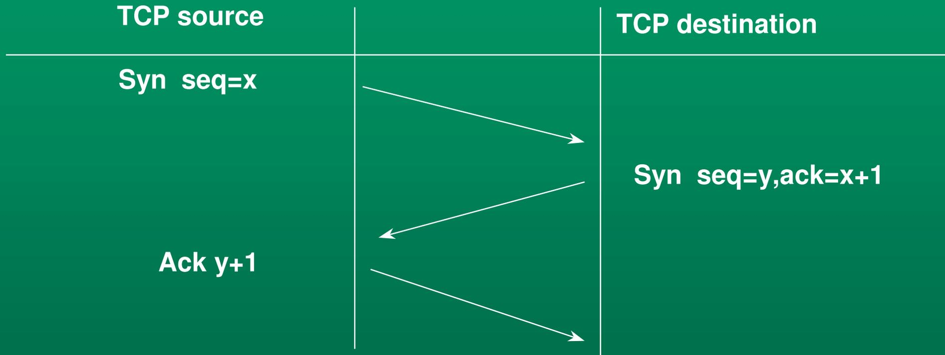
**Ce schéma fonctionne lorsque les deux extrémités effectuent une demande d'établissement simultanément. TCP ignore toute demande de connexion, si cette connexion est déjà établie.**
