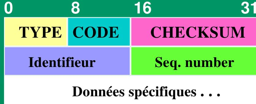
**IDENTIFIER** et **SEQUENCE NUMBER** sont utilisés par l'émetteur pour contrôler les réponses aux requêtes, (**CODE** = 0).
