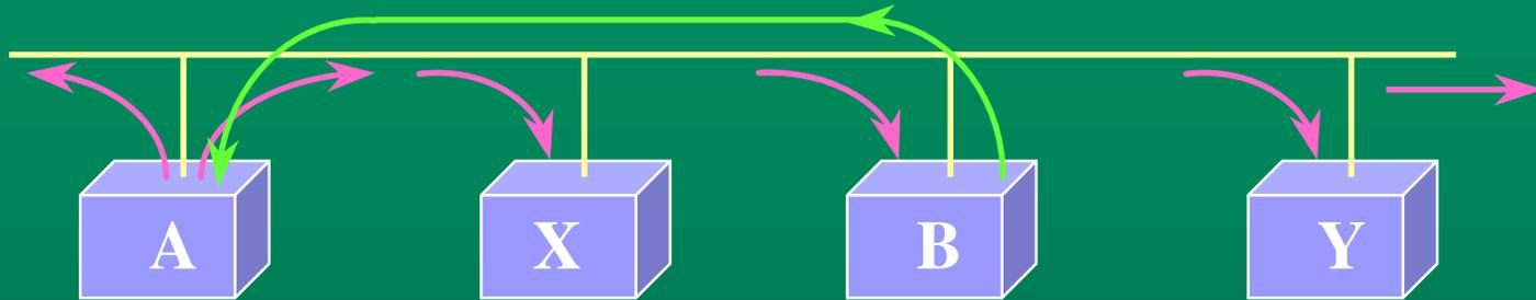
Pour connaître l'adresse physique de B, PB, à partir de son adresse IP IB, la machine A **diffuse une requête ARP** qui contient l'adresse IB vers toutes les machines; la machine B **répond avec un message ARP** qui contient la paire (IB, PB).
