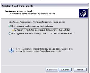
A l'écran suivant, laisser "imprimante locale" mais décocher "détection et installation automatique de l'imprimante Plug-and-play".
