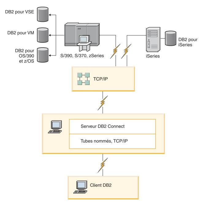
Figure 1. Connexion d'un client à un serveur de données hôte ou iSeries à l'aide de DB2 Connect
