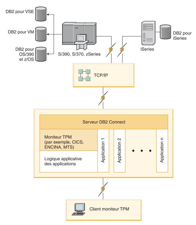
Figure 2. Moniteurs de traitement de transactions fonctionnant avec DB2 Connect.
