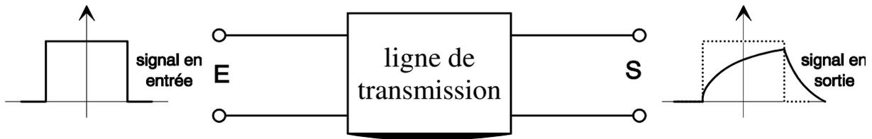
La distorsion est dite en amplitude quand les éléments constitutifs du signal, fondamental et harmoniques, ne sont pas affaiblis de façon identique. La distorsion est dite de phase quand les différents éléments du signal ne sont pas tous transmis dans le même délai. La distorsion d'amplitude est plus importante que la distorsion de phase.
