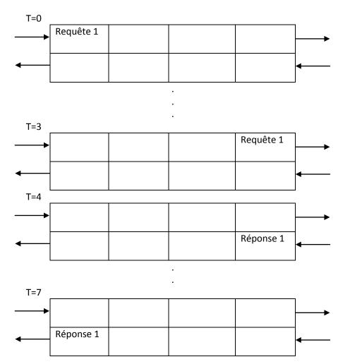
Le tube n'est utilisé qu'a 1/8 de sa capacité.
