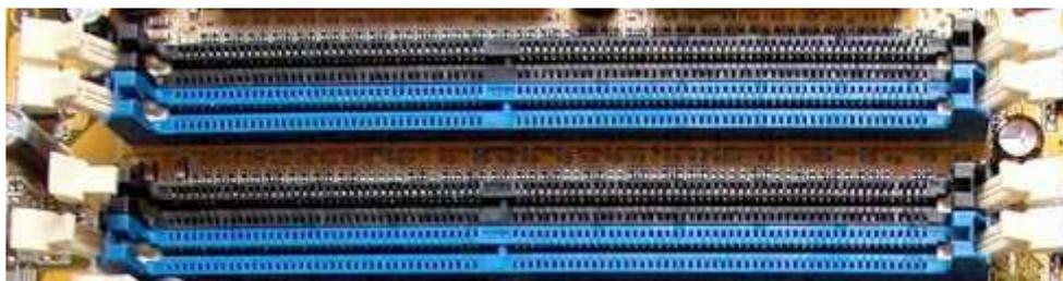
Si vous avez deux détrompeurs, il s'agit soit de SDRAM soit de RAMBUS. La RAMBUS à ses deux détrompeurs très rapprochés, alors que la SDRAM en à deux mais éloignés. La DDR et la DDR 2 n'ont qu'un détrompeur situé presque au milieu des banques (comme sur la photo).
