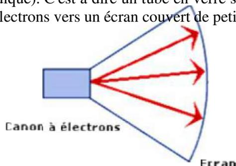
Le canon à électron est constitué d'une électrode métallique chargée négativement (la cathode), et d'une ou plusieurs électrodes chargées positivement (l'anode). La cathode émet des électrons attirés par l'anode.
