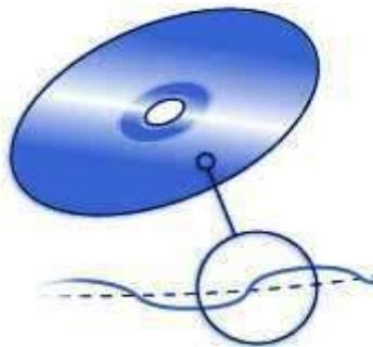
Les CD achetés dans le commerce sont pressés : les alvéoles sont réalisées par moulage du polycarbonate sur un motif inversé. Une couche métallique est ensuite coulée sur le polycarbonate, qui est ensuite pris en sandwich sous une couche de laque protectrice.
