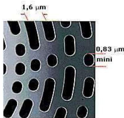
C'est la longueur de l'alvéole qui permet de définir l'information. La taille d'un bit sur le CD est normalisée et correspond à la distance parcourue par le faisceau lumineux en 231,4 nanosecondes, soit  $0,278 \mu\text{m}$  à la vitesse standard minimale de 1,2 m/s.
