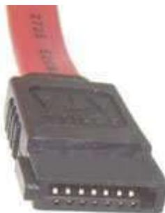
L'interface SATA (pour **Serial ATA**) est une évolution de l'IDE. La transmission des données se fait par un bus série et non parallèle, ce qui explique les faibles dimensions des nappes de
