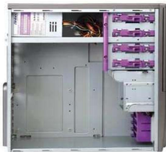
**Le format ATX 2.0 :** Simple évolution au niveau de l'alimentation, le format ATX 2.0 ne se distingue de l'ATX que par une alimentation disposant d'une prise carrée délivrant du +12 Volts.
