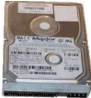
Un disque dur est constitué de plusieurs disques rigides en métal, verre ou en céramique appelés plateaux et empilés les uns sur les autres avec une très faible distance d'écart. Les plateaux tournent autour d'un axe (entre 4000 et 15000 tours par minute) dans le sens inverse des aiguilles d'une montre.
