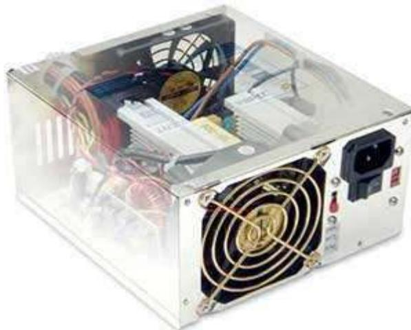
Il existe des alimentations dont la ventilation est thermorégulée : pour faire le moins de bruit possible, la vitesse du ventilateur varie en fonction de la température de l'alimentation. Plus elle chauffe, plus il tournera vite et inversement.
