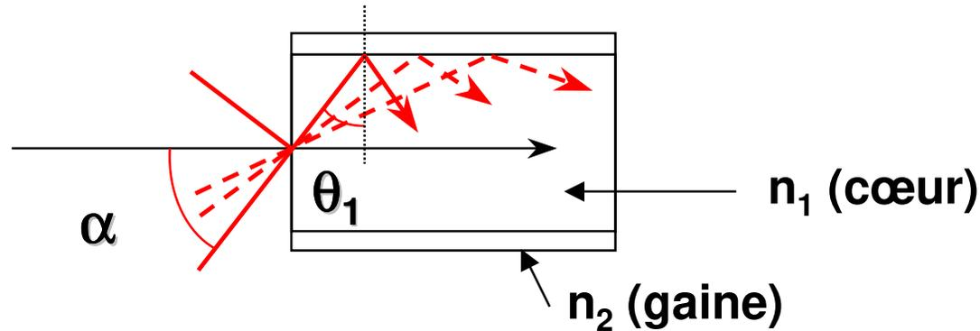
Angle d'incidence maximal à l'entrée de la fibre,
