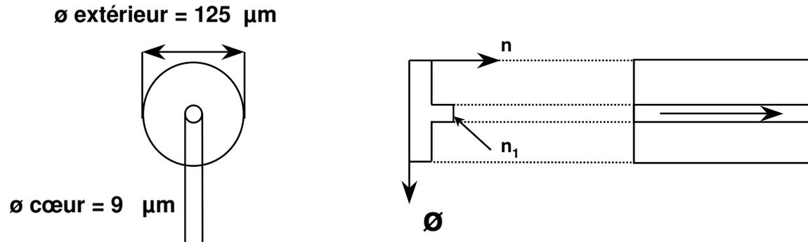
Sélection d'un seul mode de propagation se propageant au voisinage de l'axe
