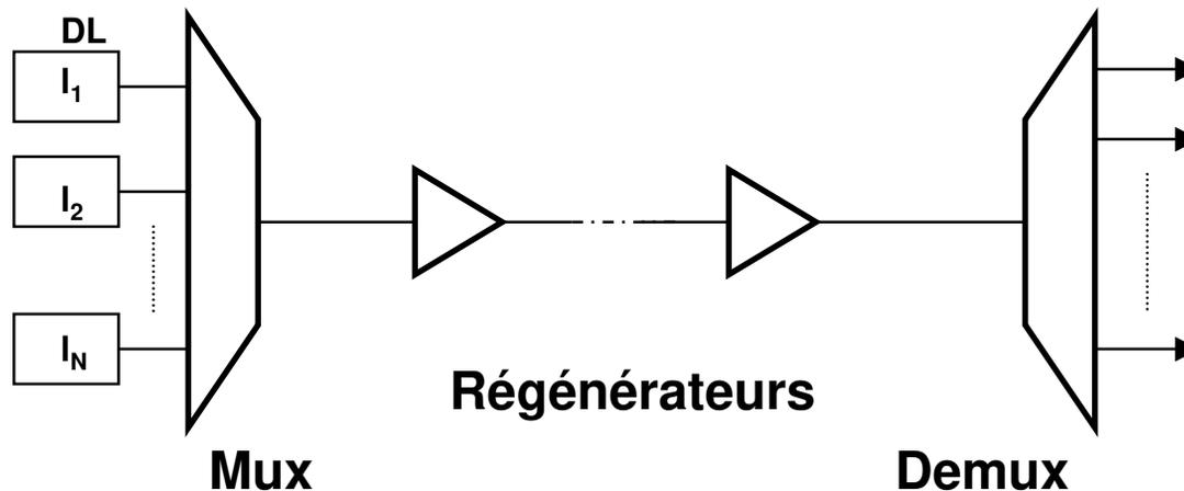
Une seule fibre permet de transmettre  $N$  canaux à  $N$  longueurs d'onde différentes.
