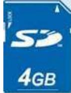
Développée début 2000 par Matsushita Electronic, SanDisk et Toshiba, la **SD Card** est également utilisée dans les appareils photo-numériques, Caméoscopes digitaux, PDA, ... Les dimensions sont normalisées: 24 mm de haut, 32 mm de large et 2,1 mm d'épaisseur. Le transfert des informations (mode série) utilise un connecteur de 9 broches
