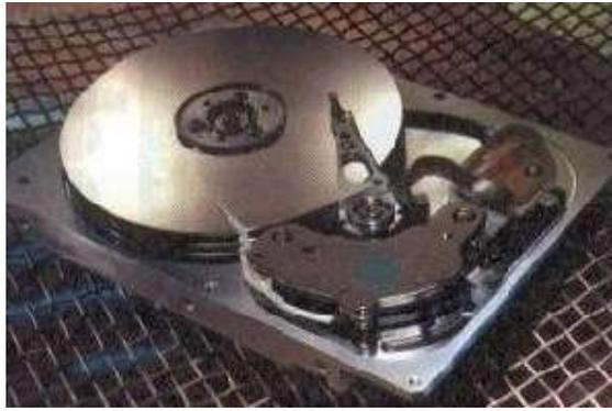
1. **plateaux** en aluminium superposés sur les quels une couche d'élément magnétique est déposée (généralement sous forme d'oxyde de fer). Quelques modèles actuels les plus performants utilisent des plateaux en verre, moins sensibles aux vibrations acoustiques et aux déformations dues à la chaleur.
