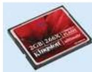
La plus ancienne est la Compact Flash (CF en abrégé), elle existe depuis 1994. Ici aussi, le contrôleur est inclus dans le boîtier. Deux types sont développées, les types I (épaisseur de 3,3 mm) et les types 2 (épaisseurs de 5 mm). Les autres dimensions sont de 42,8 mm de largeur et
