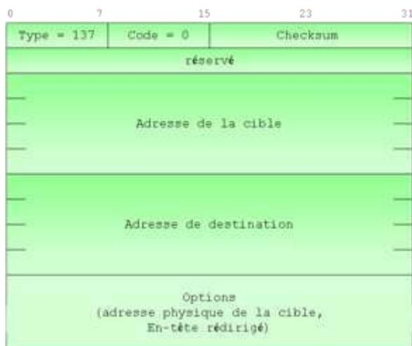
Figure 5-9 *Format des paquets d'indication de redirection*
