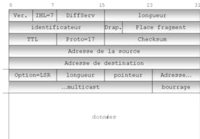
Figure 4-4 Utilisation du champ option LSR d'IPv4
