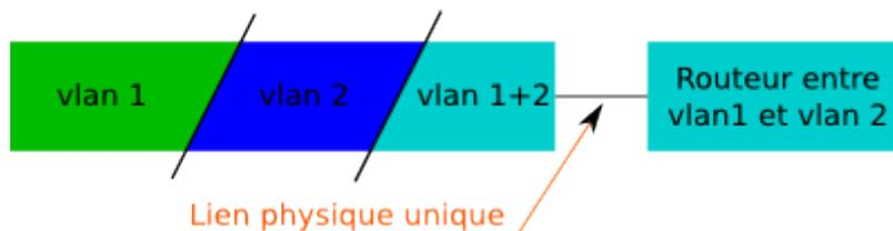
Dans notre exemple, le SWITCH est configuré pour supporter deux VLANs, respectivement d'ID 1 et 2. Les ports verts appartiennent au VLAN d'ID 1 et les ports bleus au VLAN d'ID 2. Aucun de ces ports n'a besoin d'être "taggué" puisqu'ils n'appartiennent qu'à un seul VLAN.
