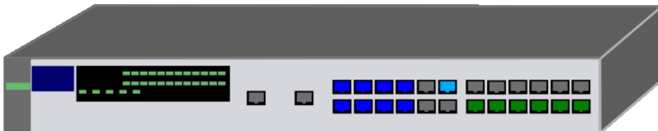
Sur un même SWITCH physique, nous allons pouvoir créer plusieurs LANS et assigner certains de ses ports aux divers LANS créés. Ici, nous avons un LAN bleu et un LAN vert. Laissons pour le moment les ports gris de côté.
