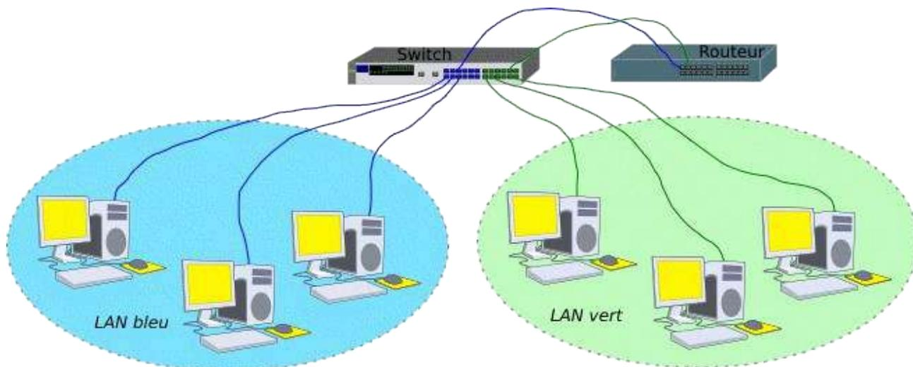
Le SWITCH a été virtuellement coupé en deux. Les deux VLANs sont complètement étanches au niveau Ethernet (Un SWITCH est en principe un outil qui ne va pas au delà du niveau 2). Pour interconnecter ces deux LANS, un routeur est toujours nécessaire.
